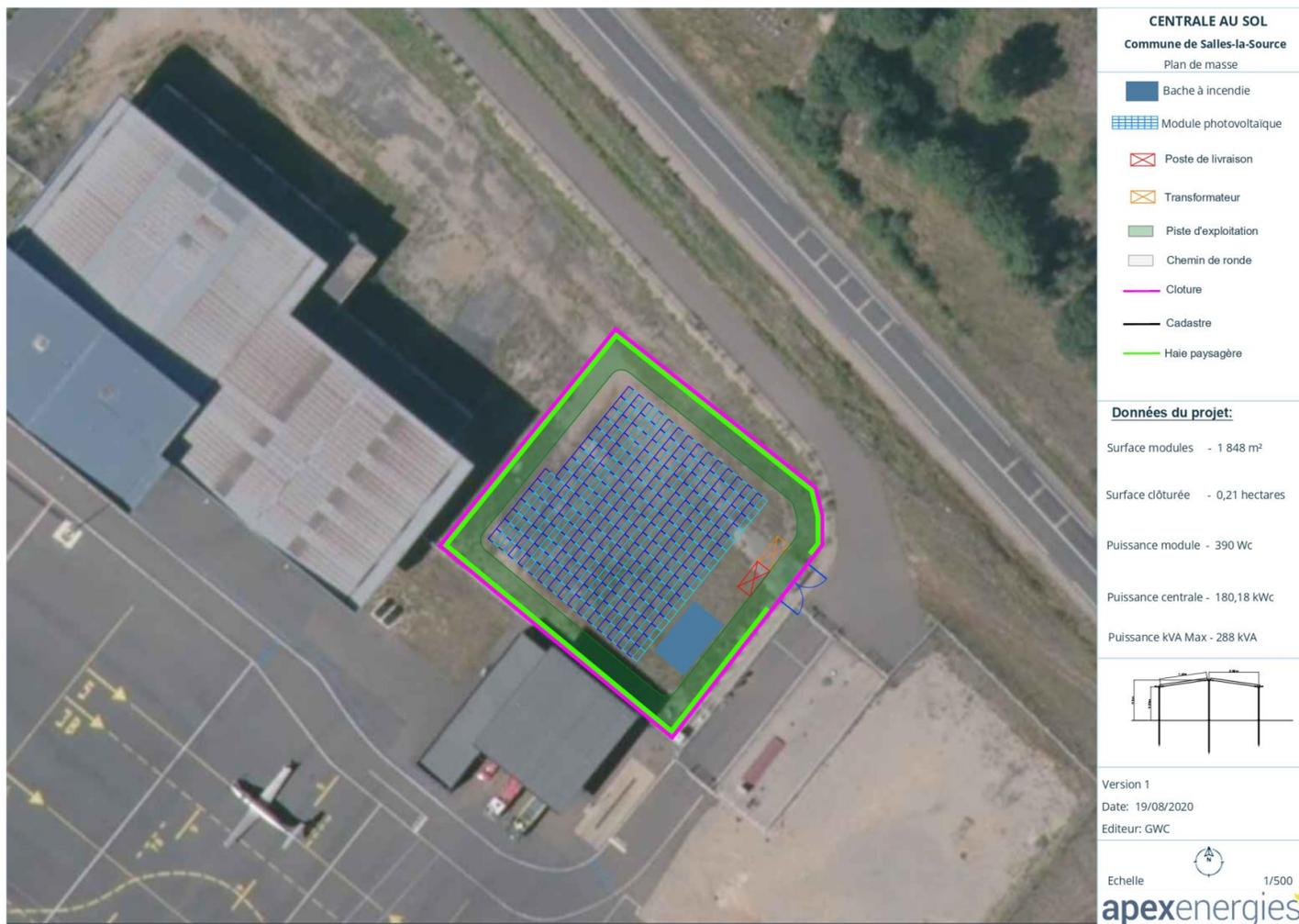
Figure 2 : Plan de masse de l'option n°2 de centrale au sol en autoconsommation
